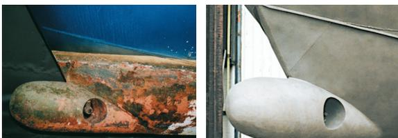
*Korrodiertes Stahlrumpf vor / nach dem Strahlen*
