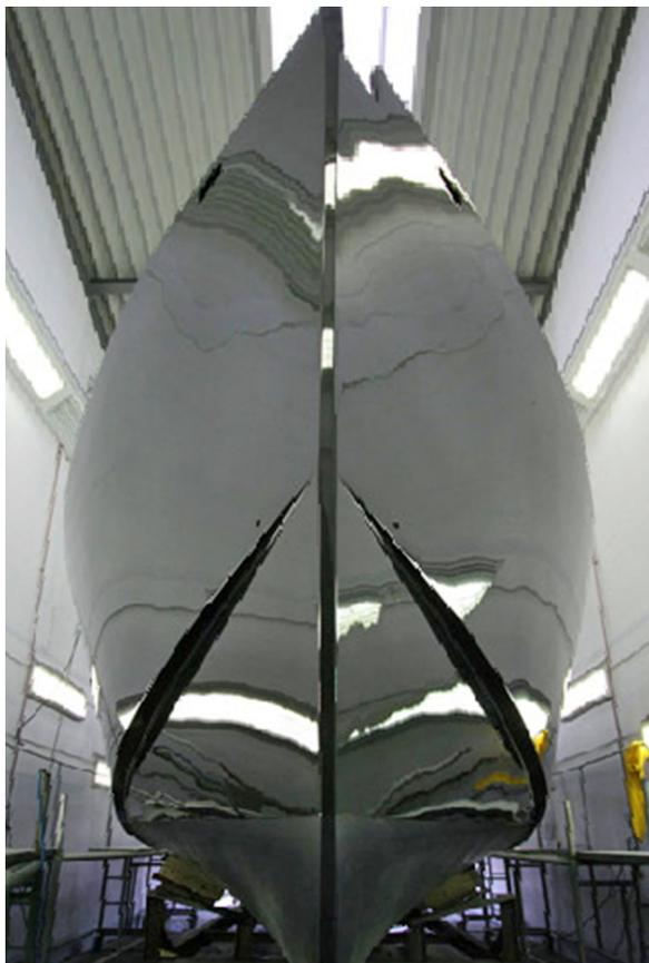
In der diagonalbelüfteten Lackieranlage wird bei optimalen Temperatur- und Lichtverhält- nissen der Lack in sechs Spritzgängen aufge- tragen. Wiederum bei ca. 40°C wird das glän- zende Schutzschild dann vollständig ausge- härtet.
