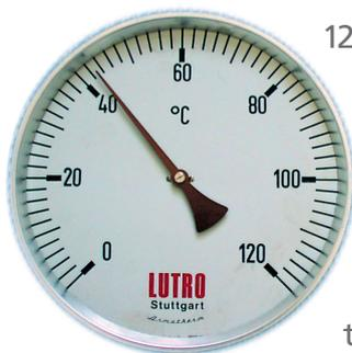
12 Stunden wird die Grundierung bei etwa 40°C ausgehärtet. Die Löse- mittel werden so vollständig ausge- tempert. Dies stellt die Wasserdampfdichtig- keit der Grundierung sicher.
