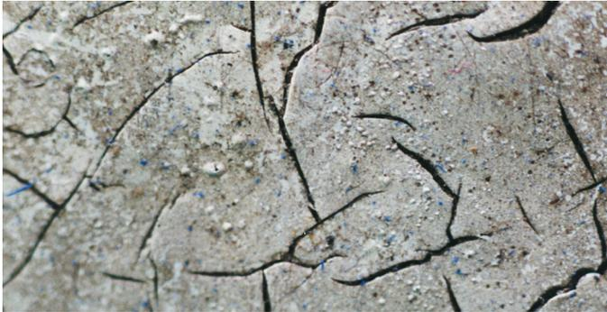
Stark gealtertes Gelcoat unter dem Mikroskop: Deutlich sichtbar sind die Haarrisse, in denen der Schmutz und die Feuchtigkeit der letzten Saisons festsitzen! Kein Wunder, dass selbst mühsames Polieren das matte, poröse Gelcoat nur für kurze Zeit wieder glänzen lässt. Zeit für eine Spritzlackierung mit 2K-Polyurethan-Lack.
