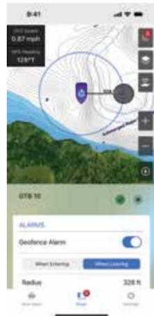
Erfahre als Erster, wenn ein Sicherheitssensor ausgelöst oder dein Boot bewegt wurde. Der interne GPS-Sensor wird je nach Leistungsstatus alle 15 oder 30 Minuten aktualisiert und sendet Text-Alarme<sup>1</sup>, wenn dein Boot den per Geofencing begrenzten Bereich verlässt.
