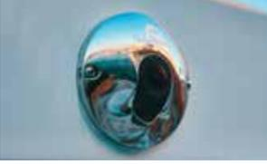
Die werksseitige Montage durch den Rumpf sorgt für einen sicheren Sitz und eine gute Kalibrierung des Surround View-Kamerasystems. Für eine einfache Wartung kann jede Kamera von außen ausgetauscht werden.
