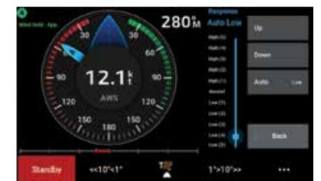
Automatische Anpassung der Reaktionseinstellungen basierend auf See- und Windbedingungen. Die Reaktion wird bei ruhigen Bedingungen reduziert, um ein überaktives Ruder zu vermeiden, und bei rauen Bedingungen erhöht, um auf Wind- und Welleneinflüsse zu reagieren.
