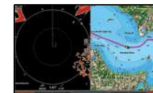
Dual-Range-Einblendungen mit gleichzeitiger Anzeige auf dem Split Screen.
