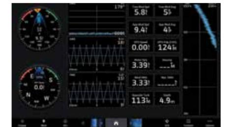
Übersichtliche Diagramme der tatsächlichen Windrichtung, des scheinbaren Windwinkels, der tatsächlichen Windgeschwindigkeit und der scheinbaren Windgeschwindigkeit.
