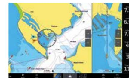
Einrichtung einer doppelten Navigationskartendarstellung mit Nord-Up- und Kurs-Up-Ausrichtungen. Diese gleichzeitige Ansicht verbessert das Bewusstsein für die Kursrichtung und die breitere Positionierung.
