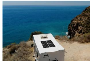
Die Maxa-Serie wurde als ideales Solarmodul für den Einsatz auf Wohnmobilen und Transportern entwickelt und zeichnet sich durch eine Verarbeitungsqualität und Langlebigkeit aus, die den Wettbewerb in den Schatten stellt. Das geringe Gewicht und die Dicke von 3 mm machen es perfekt für die Integration auf dem Dach. Die ETFE-Oberfläche lässt sich bei einem gelegentlichen Regenschauer leicht reinigen.
