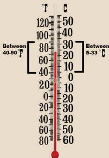
Beim Verfugen sollte die Umgebungstemperatur zwischen 5-33°C liegen. In den Tropen sollte im Schatten gearbeitet werden um zu vermeiden, dass die unausgehärtete Masse aus den Fugen sprudelt. Bei niedrigeren Temperaturen benötigt das Material zusätzliche Zeit zum Aushärten.
